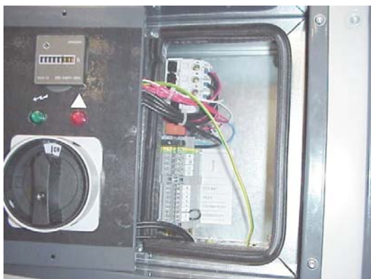
Рис. 4.1 Контактная колодка расположена за правой панелью управления.
